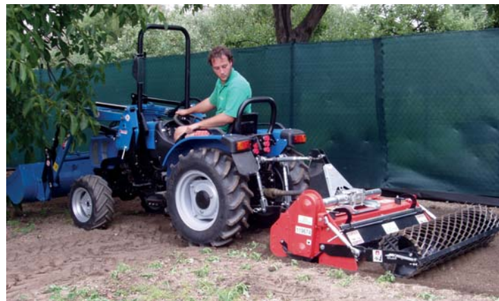
Půdní fréza Muratori půdu nejen prokypří a urovná, ale zapraví i kameny pod povrch
